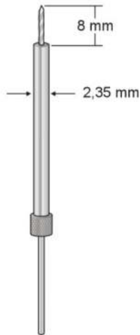
Special Drill Spezialbohrer Ø 1,7 mm
